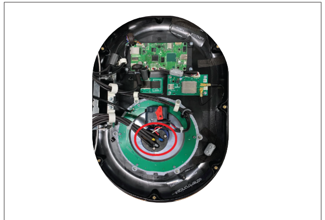
Abb. 38 Positionen der Siegel innerhalb der vorderen Abdeckung
