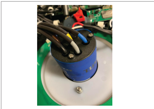
Abb. 41 Sockel mit Kabel und Siegelaufkleber
