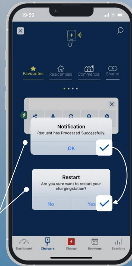
Sie hören einen Ton von der Ladestation, der den Neustart bestätigt. Zusätzlich wechselt die LED-Farbe.
